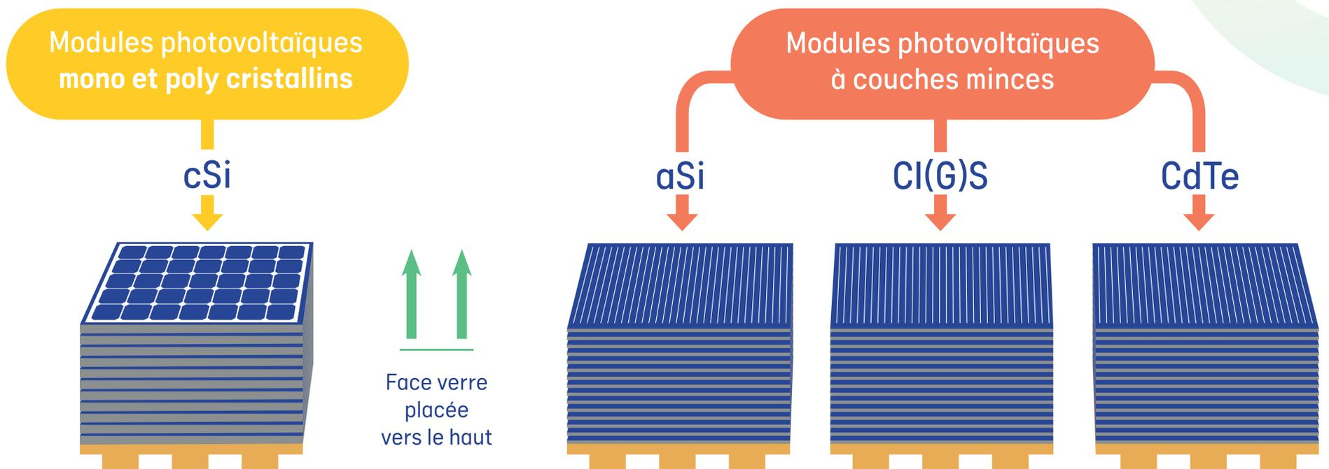
Les panneaux photovoltaïques doivent être **propres, complets** et **stockés à l'abri de l'eau**.
